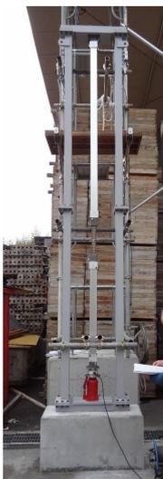
高山資材センターに、支柱の試験架台を設置、アルミ角管支柱75角の試験を行いました。が、架台を設置したので、今後の開発に期待が持てます。
